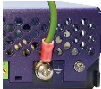
Borne de terre à l'arrière de OTU
