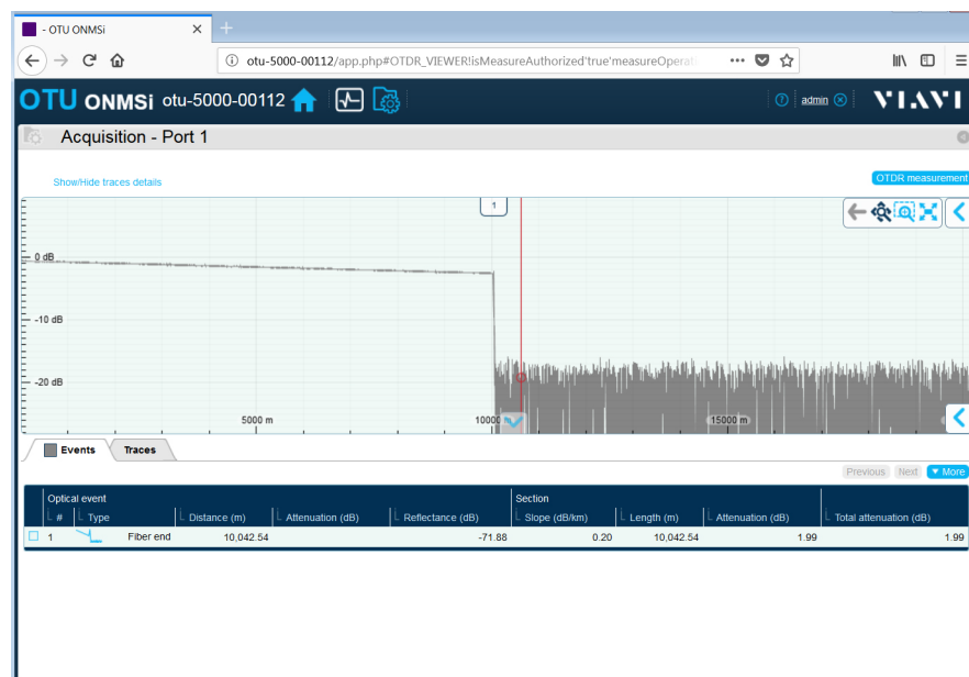
Figure 40 Résultat d'une mesure OTDR
