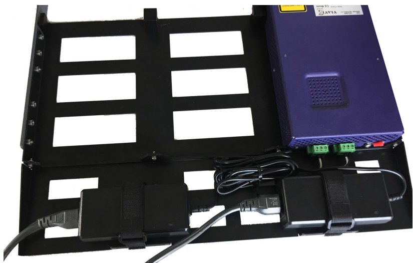
Figure 15 Double alimentation installée sur le panneau arrière
