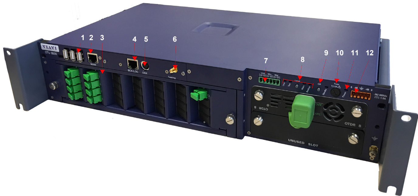
Figure 16 Panneau avant OTU-8000
