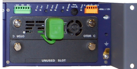
Tiroir OTDR installé dans l'OTU-8000 (configuration avec un seul OTDR).
