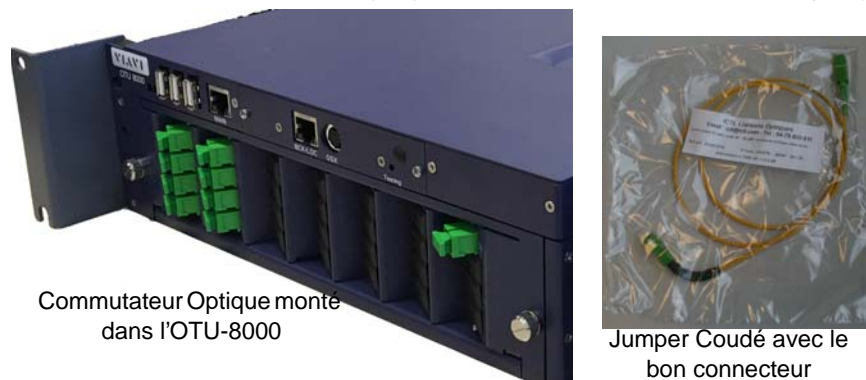
Figure 10 Module Commutateur Optique installé dans l'OTU-8000 et jumper coudé
