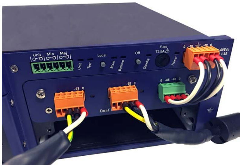
Figure 23 Branchement pour la double alimentation
